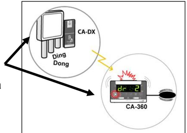
**Installez l'appareil sur un carillon de porte existant ou sur un interphone de porte pour détecter les vibrations.**
